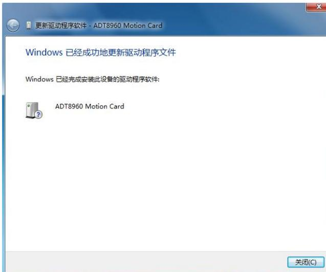
即完成 ADT-8960 卡的安装。**注意：WIN7 系统需要管理员权限对 PCI 驱动进行加载，如果第一次运行控制卡应用程序直接双击，会导致控制卡初始化失败，所以在第一次安装完成后，必须对控制卡应用程序（比如 VC 示范程序“DEMO.EXE”）按鼠标**
