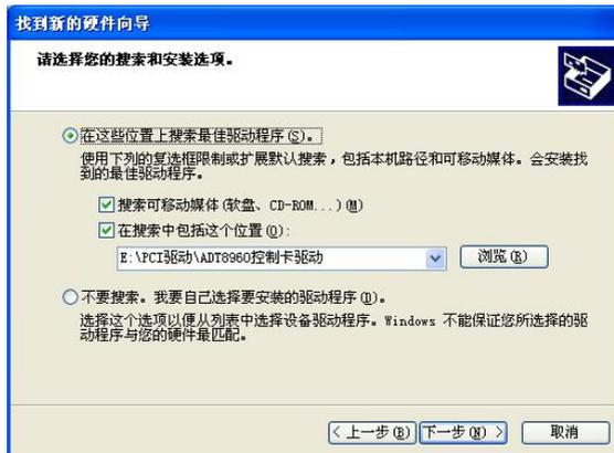
点击“浏览”按钮, 选择光盘“开发包\驱动控制卡驱动程序”, 即可找到 ADT8960.INF 文件的路径, 点击“下一步”, 出现如下界面
