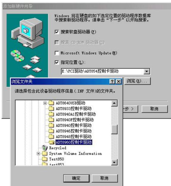
点击“浏览”按钮，选择光盘“开发包\驱动\控制卡驱动程序”，即可找到 ADT8960.INF 文件的路径，点击“确定”，出现如下界面
